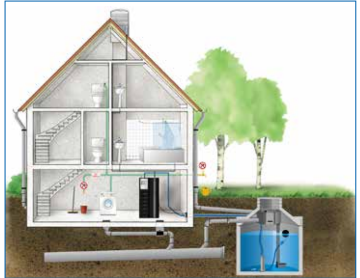
AQUAFIX REGENWATERHERGEBRUIKSYSTEEMEN: TYPE GARDEN MET EEN PE TANK.
