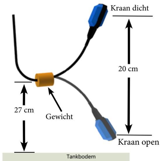
**NL:** De kabel van de vlotter naar de besturing kan eventueel verlengd worden. Let hierbij op een waterdichte verbinding. De kabel mag niet zonder beschermingsbuis onder de grond geplaatst worden. We adviseren om een mantelbuis DN 110 toe te passen waar tevens de zuigleiding en eventuele filterspoelleiding doorheen gevoerd kunnen worden.
