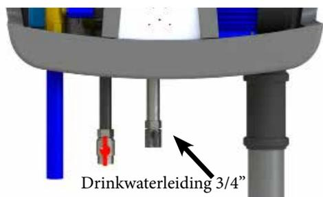
6 NL: Sluit de drinkwaterleiding aan op de meegeleverde kraan. Sluit vervolgens de kraan aan op de 3-delige flexibele slangkoppeling. Bij aanleg van de waterleiding kan er vuil en slijpsel in de waterleiding geraken. Dit zal het ventiel in het toestel doen lekken. Indien dergelijke vervuiling niet uitgesloten kan worden dient de leiding na aanleg eerst doorgespoeld te worden alvorens deze op het toestel aan te sluiten. Monteer vervolgens de vlotterschakelaar in de regenwatertank.
