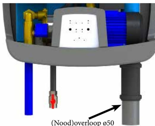
5 NL: Met behulp van een steekmof dient het apparaat op het riool, de tank of een pompinstallatie aangesloten te worden. Let op dat deze leiding minimaal 50 mm is en niet verjongd mag worden. Indien er gebruik gemaakt wordt van een pompinstallatie richting het riool betracht dan de minimale pompcapaciteit daarvan. Deze dient minimaal 3.000 L/h te zijn.
