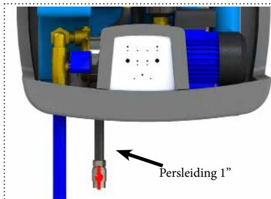
4 NL: Sluit de persleiding op de meegeleverde kraan aan. Sluit vervolgens de kraan aan op de 3-delige flexibele slangkoppeling. Gebruik hiervoor het fiberringetje uit het aansluitset van de Watermanager. Monteer de persleiding met een beugel met rubber mantel op de wand. Dit voorkomt resonanties in het leidingnet.
