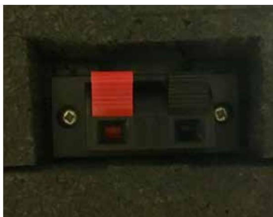
**NL:** Sluit nu de kabel van de vlotterschakelaar aan op het toestel. Gebruik hiervoor de speakerklemmen onderaan de Watermanager. Sluit de blauwe ader van de kabel van de vlotter schakelaar aan op de rode klem. Sluit daarna de bruine ader van de kabel van de vlotter schakelaar aan op de zwarte klem. Druk de ongeïsoleerde aders diep in de klem en sluit deze. De geel / groene kabel (aarde) hoeft niet aangesloten te worden.
